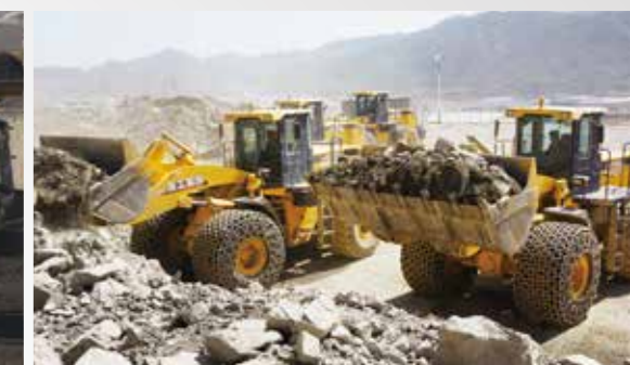
Погрузчик LW900K XCMG перегружает фосфорные руды
